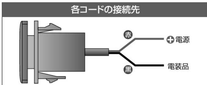
「各コードの接続先」と台紙記載の「配線例」を参考に配線コードを接続してください。接続には端子・コネクターなどを使用し、確実に接続してください。
