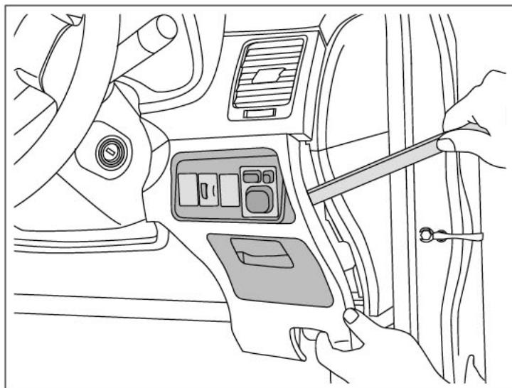
パネルはがし(別売)を使って丁寧に外してください。ネジ止め箇所がある場合はドライバーを使用して外してください。
