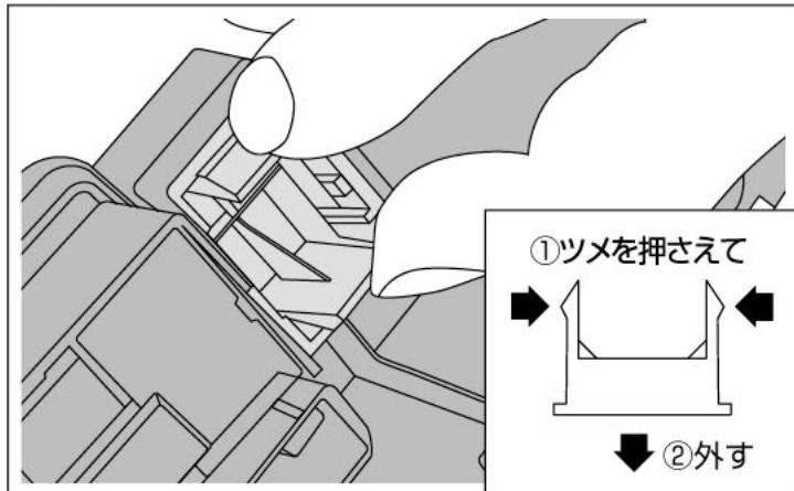
パネル裏側のツメを押さえて、前方に押し出すように取り外してください。
