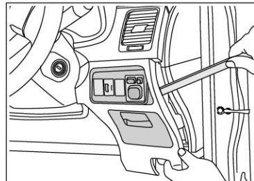
パネルはがしを使って丁寧に外してください。ネジ止め箇所がある場合はドライバーを使用して外してください。
