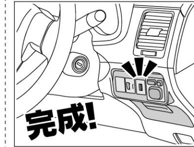
手順⑥で外した純正コネクターを接続して、取り外した周辺パネルを元に戻してください。
