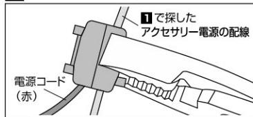
手順①で探し出した配線に付属の電源コード(赤)のコネクターを接続してください。接続コネクターは、カチッとロックされるまでプライヤーで確実に挟み込んでください。
