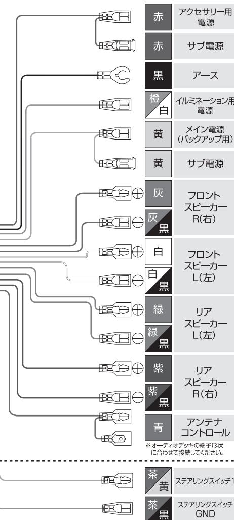
純正ステアリングリモコン対応機能付カーオーディオ・カーナビゲーションを取り付ける場合に使用します。取り付ける機器によってステアリングリモコン用コードの配線色は異なります。
