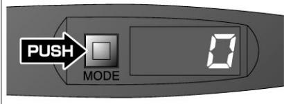
本体の電源スイッチをONにし、モード切り替えスイッチで電圧測定モードにセットしてください。
