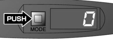
本体の電源スイッチをONにし、モード切り替えスイッチで電圧測定モードにセットしてください。
