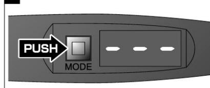
本体の電源スイッチをONにし、モード切り替えスイッチで導通確認モードにセットしてください。
