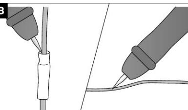
テスターの先端をチェックしたいコードの端子部に接触させるか、コード自体に突き刺してください。
