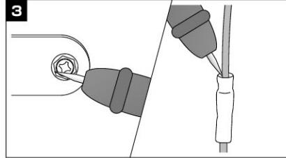
テスターの先端をチェックしたいボルトに接触させてください。コードの場合は端子部に接触させるか、コード自体に突き刺してください。
