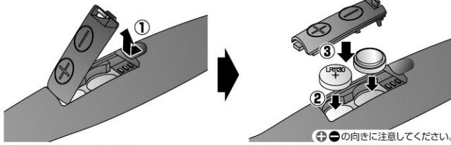
※付属のボタン電池は動作確認用です。ご使用の前に新品のボタン電池に交換してください。
