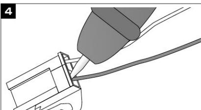
テスターの先端をチェックしたいカブラーの端子部に接触させるか、コード自体に突き刺してください。
