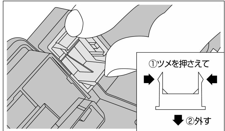
パネル裏側のツメを押させて、前方に押し出すように取り外してください。
