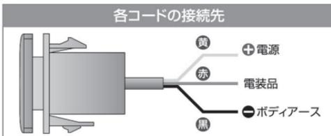
「各コードの接続先」と台紙記載の「配線例」を参考に配線コードを接続してください。接続には端子・コネクタなどを使用し、確実に接続してください。
