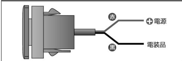
「各コードの接続先」と台紙記載の「配線例」を参考に配線コードを接続してください。接続には端子・コネクターなどを使用し、確実に接続してください。
