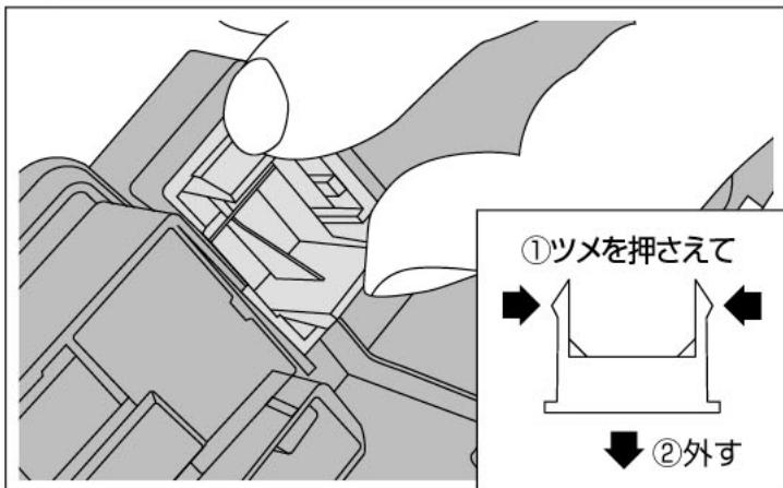
パネル裏側のツメを押さえて、前方に押し出すように取り外してください。
