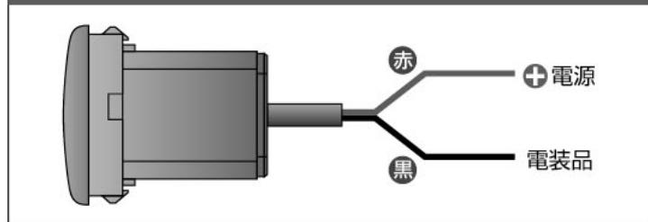
「各コードの接続先」と台紙記載の「配線例」を参考に配線コードを接続してください。接続には端子・コネクターなどを使用し、確実に接続してください。
