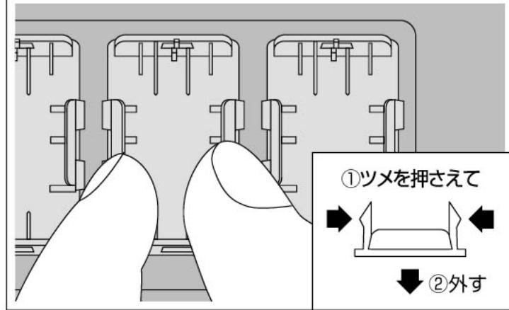
パネル裏側のツメを押させて、前方に押し出すように取り外してください。
