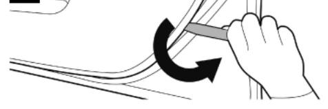
内張りはがしをインナーパネルと内張りの間にさし込み、スライドさせて「コツン」とあたる部分を探します。
