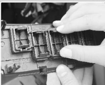
パネル裏側のツメを押さえて、前方に押し出すように取り外してください。
