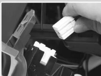
純正スイッチなどのコネクターが接続されている場合は、外したパネルから純正コネクターを抜いてください。
