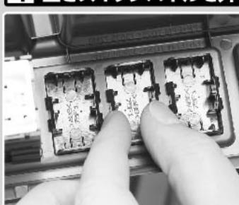
パネル裏側のツメを押さえて、前方に押し出すように取り外してください。
