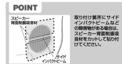
取り付け箇所にサイドインパクトビームなどの障害物がある場合は、スピーカー背面制振吸音材をカットして貼り付けてください。
