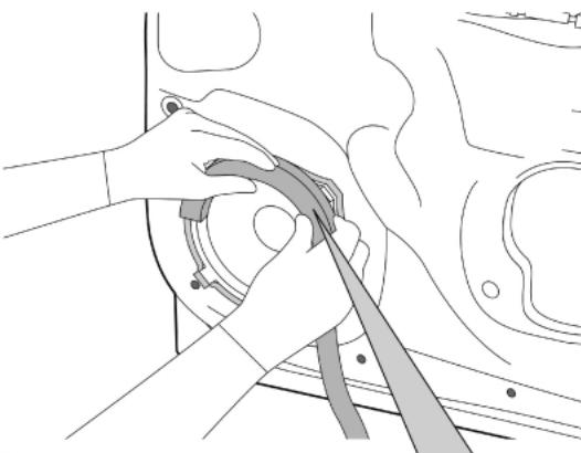
下記イラストを参考に、スピーカーのフレーム部分に沿ってスピーカー用防音テープを貼り付けてください。余った部分はハサミなどでカットしてください。
