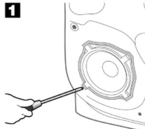
スピーカー・スピーカーマウントを取り外し、接続されているコネクターも外してください。
