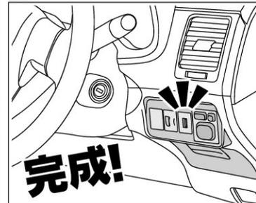
手順6で外した純正コネクターを接続して、取り外した周辺パネルを元に戻してください。
