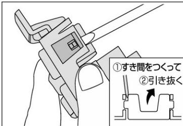
マイナスドライバーなどを使用してツメのロック部分にすき間を作り、後方に引き抜くように取り外してください。
