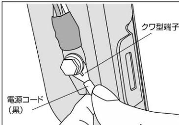
車両の金属部分(ボルト部)に付属の電源コード(黒)を接続してください。
