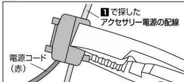
手順1で探し出した配線に付属の電源コード(赤)のコネクターを接続してください。配線コネクターは、カチッとロックされるまでプライヤーで確実に挟み込んでください。
