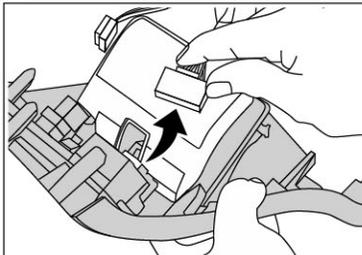
純正スイッチなどのコネクターが接続されている場合は、外したパネルから純正コネクターを抜いてください。
