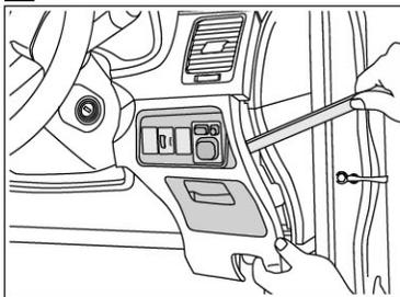
パネルはがしを使って丁寧に外してください。ネジ止め箇所がある場合はドライバーを使用して外してください。
