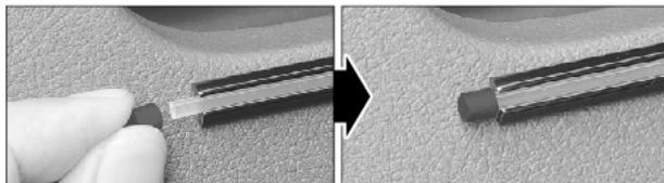
8 エンドキャップAに両面テープを貼り付け、リケイ紙をはがして光漏れ防止キャップの上からかぶせて取り付けで完成です。
