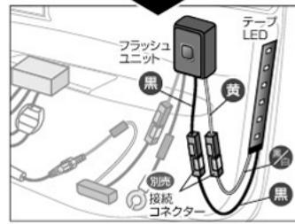
細線変換ハーネス(別売)のクリップ端子を車体金属部のボルトと共に締めしてボディアースを取ります。
