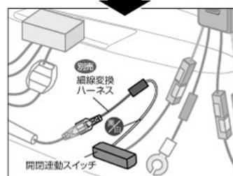
細線変換ハーネス(別売)と開閉連動スイッチの黒／白線を圧着端子で接続します。
