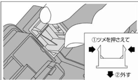
裏側から空きスイッチパネルのツメを押さえて、前方に押し出すように取り外す。
