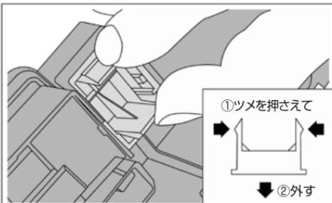
裏側から空きスイッチパネルのツメを押さえて、前方に押し出すように取り外す。
