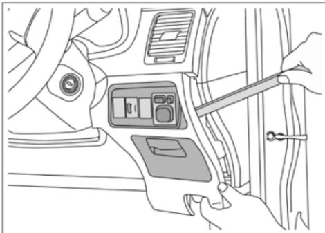
パネルはがし(別売)を使って周辺パネルを取り外す。ネジ止め箇所がある場合はドライバーを使用する。
