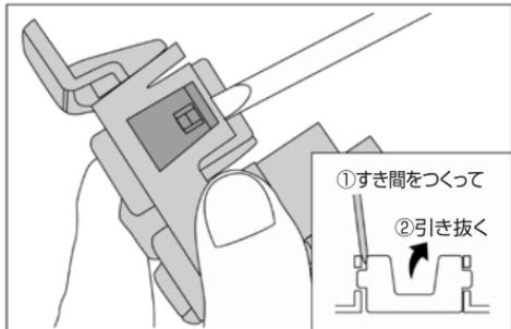
マイナードライバーなどを使用してツメのロック部分にすき間を作り、後方に引き抜くように取り外す。
