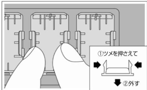
裏側から空きスイッチパネルのツメを押させて、前方に押し出すように取り外す。
