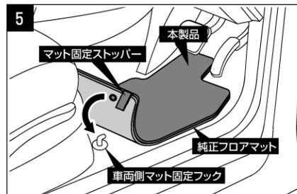
セットした純正フロアマットを車両側のマット固定フックに差し込んで確実に固定してください。
