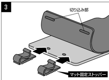
本製品の裏面にある各2箇所の切り込み部分に合わせて、マット固定ストッパーの取り付け位置を決め、固定ストッパーを純正フロアマットに取り付けてください。
