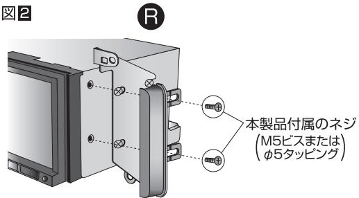
※本体の刻印で**L** **R**を確認してください。図1・2は右側**R**への取り付け方法です。
