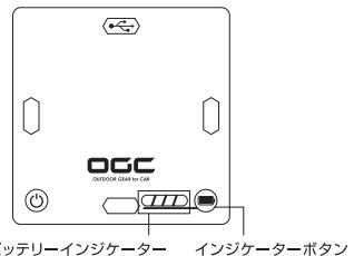
インジケーター②を押すと、バッテリーインジケーターが点灯し、残量を5段階で表示。約5秒後に消灯。
