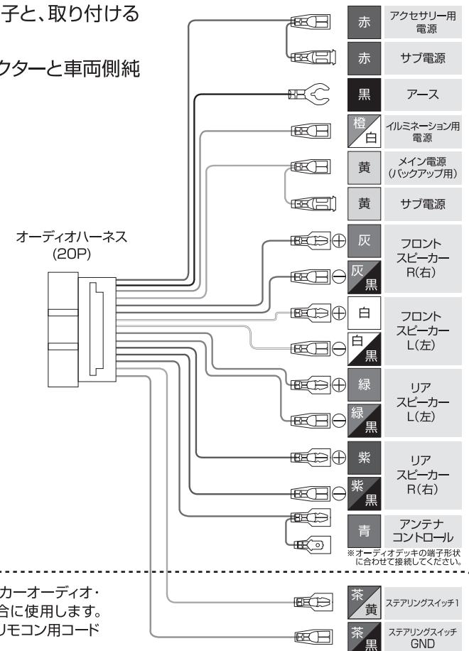
純正ステアリングリモコン対応機能付カーオーディオ・カーナビゲーションを取り付ける場合に使用します。取り付ける機器によってステアリングリモコン用コードの配線色は異なります。
