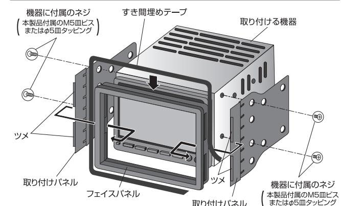
取り付けパネルの2箇所のツメをフェイスパネルの内側に合わせる。
