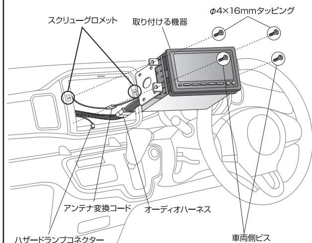
4. センターパネルにハザードランプコネクターを接続した後、車両に取り付ける。
