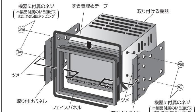
取り付けパネルの2箇所のツメをフェイスパネルの内側に合わせてください。
