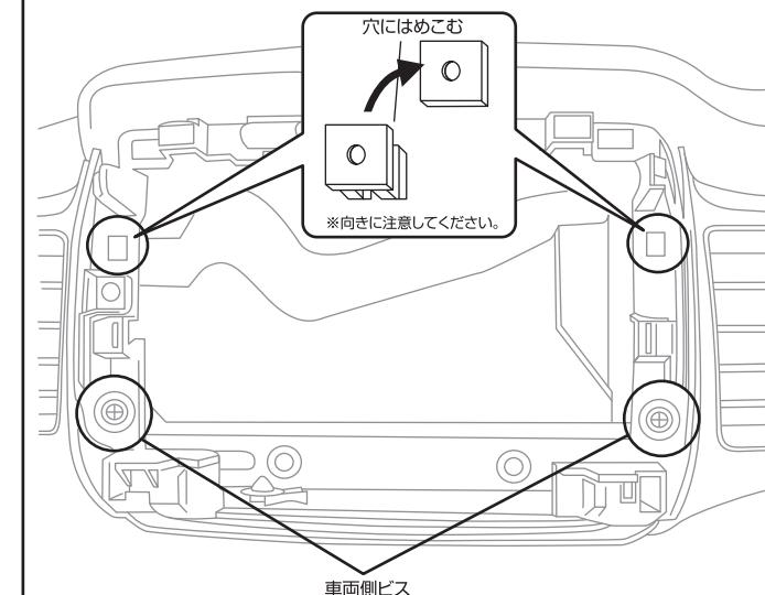
3. 取り付ける機器を付属のタッピングと車両側ビスでしっかりと固定する。
