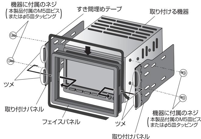
取り付けパネルの2箇所のツメをフェイスパネルの内側に合わせてください。
