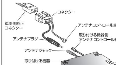
※取り付ける機器のアンテナコントロール端子が平型端子の場合は、付属の平型端子変換コードを併用して接続してください。
