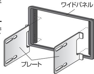
※ワイドパネルの一部が車両側金具などに干渉する場合は、干渉部分を切断してください。
