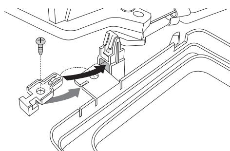
※固定プレートが■部に入るよう変換パネルを純正パネルに挿入してください。
